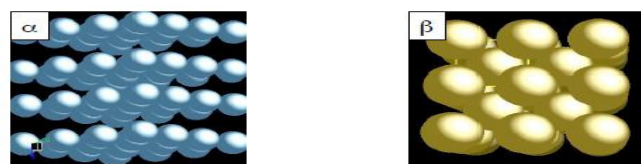
Figura 1 - Estrutura cristalina do titânio (fase \alpha ) e (fase \beta ).
