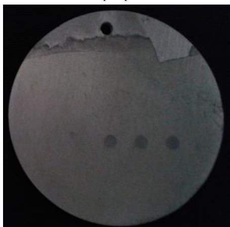
Figura 6 – Calotas geradas no ensaio de desgaste para revestimento obtido pelo procedimento 1.
