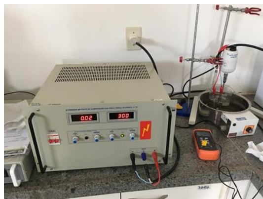
Figura 2 – Fonte de corrente contínua empregada para o procedimento de plasma eletrolítico e sistema acoplado.
