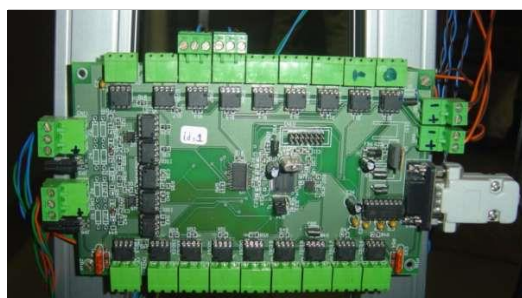
Figura 6 – Placa Arbiter e o gerenciamento de dados entre as placas receptoras e o computador.
